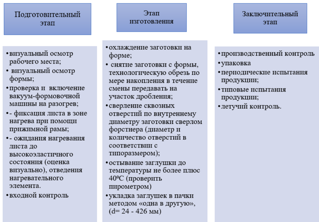
Рисунок 1 - Этапы технологического процесса изготовления заглушки
